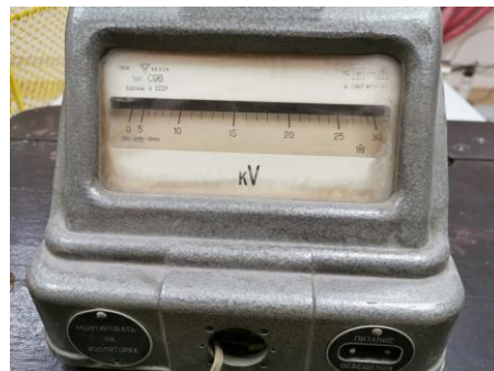
Fig. 4 – kV-metru electrostatic utilizat pentru măsurarea tensiunii remanente pe izolația cablului
